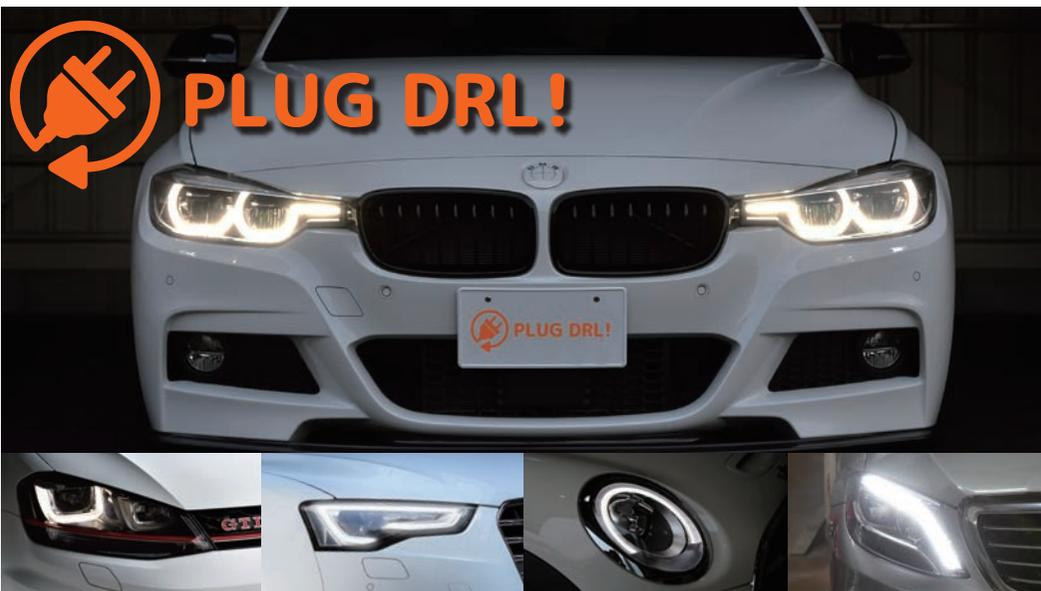
PLUG DRL!は、LED ポジションランプ付ヘッドライトのポジション部をデライト化する製品です。キーON及びエンジン始動中にデライトとして点灯します。
